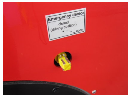
Notlaufsicherung „geöffnet“ (Fahrzeug kann abgesenkt werden)
