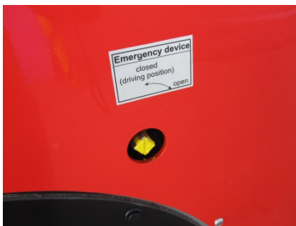
Notlaufsicherung in Fahrstellung
