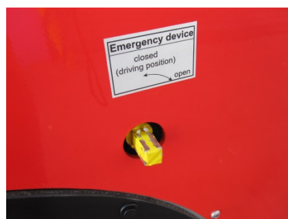
Disp. de sécurité „ouvert“ (véhicule peut être abaissé)
