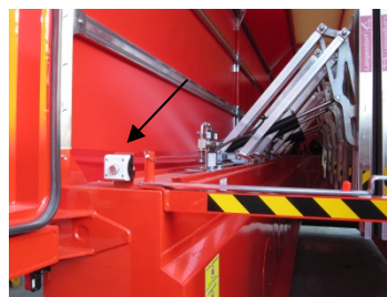
Pontage du verrouillage de porte
