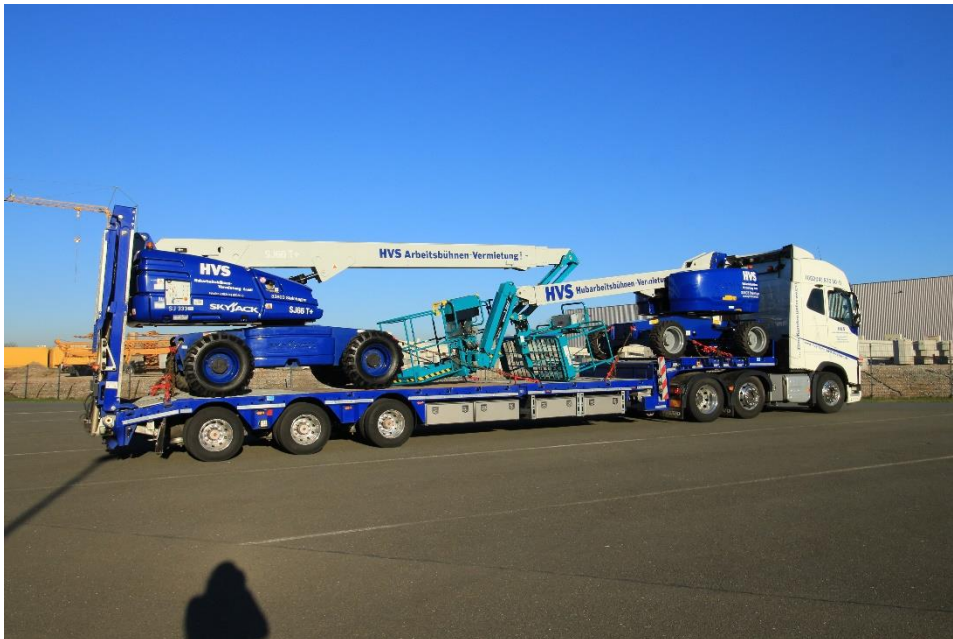
Bild 2: Spezial-Tieflader SATÜ 30-H von Langendorf mit zwei Hubarbeitsbühnen der HVS Hubarbeitsbühnen GmbH
