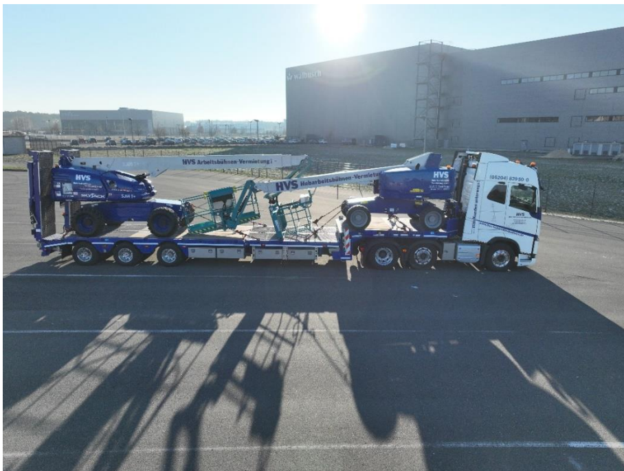
Bild 1: Spezial-Tieflader SATÜ 30-H von Langendorf mit zwei Hubarbeitsbühnen der HVS Hubarbeitsbühnen GmbH
